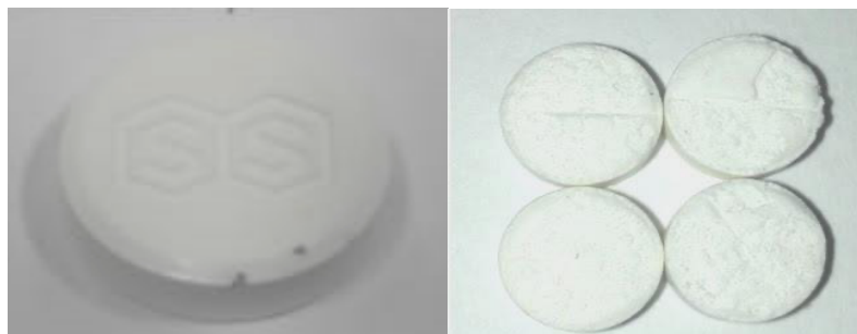
Gambar 2. Cacat Bintik Hitam (Kiri) dan Sticking (Kanan) Pada Tablet
